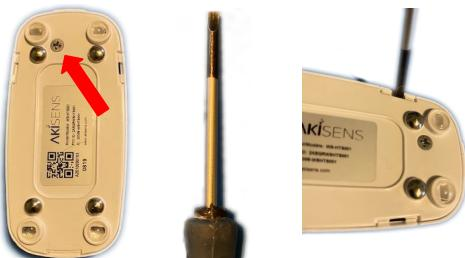
2. Insérez une pile AA dans le capteur et fermez le couvercle. Remarque: Insérez d'abord le connecteur noir dans le trou (couvercle) du boîtier du haut.
