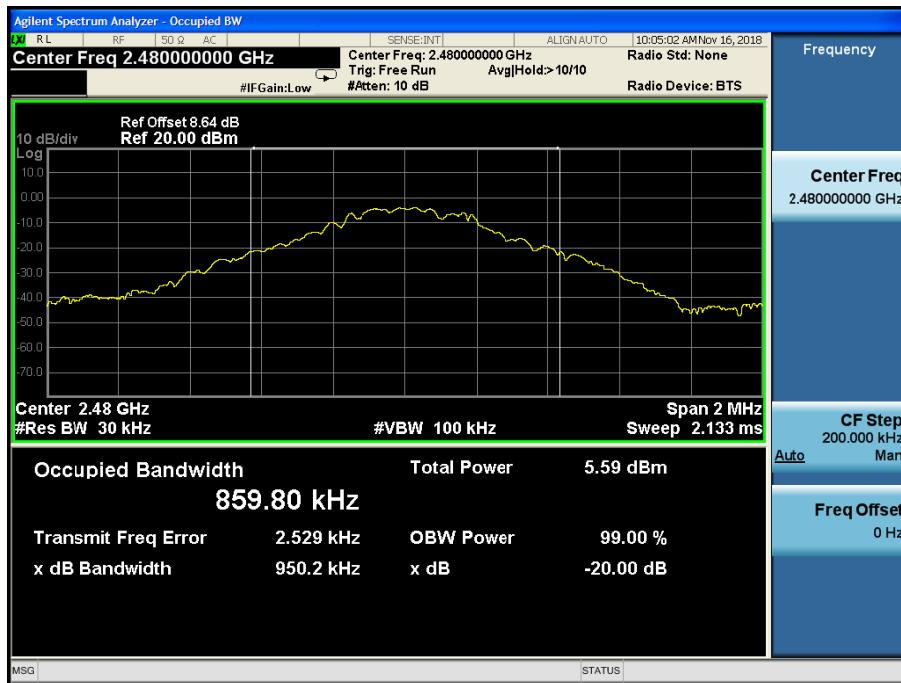
Test Mode:  $\pi/4$ DQPSK
