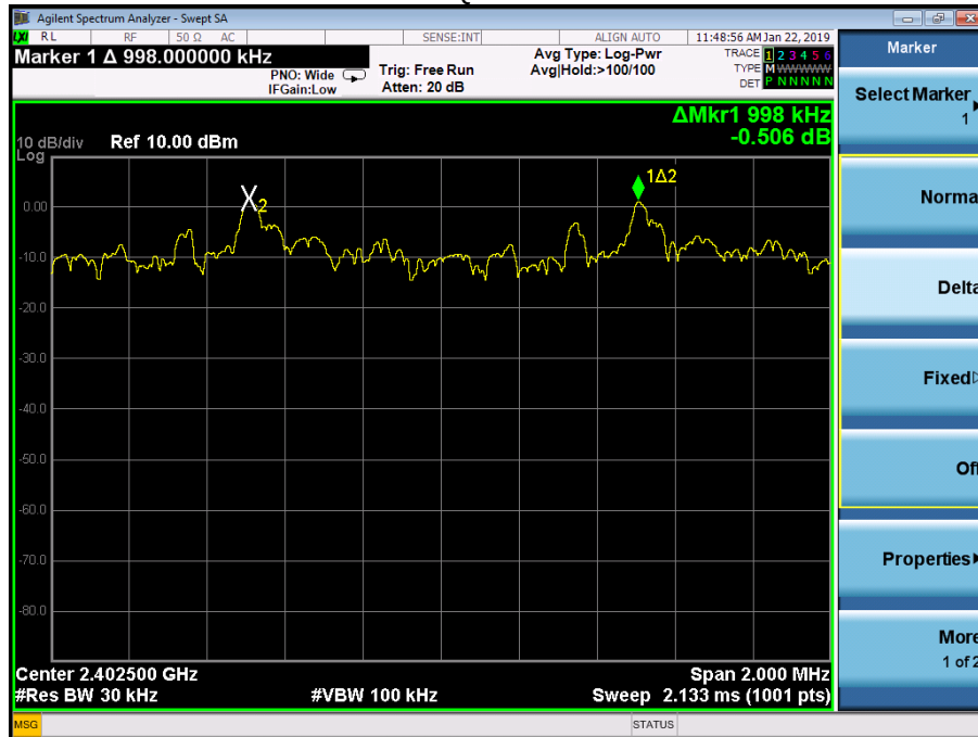
Pi/4 DQPSK Low Channel
