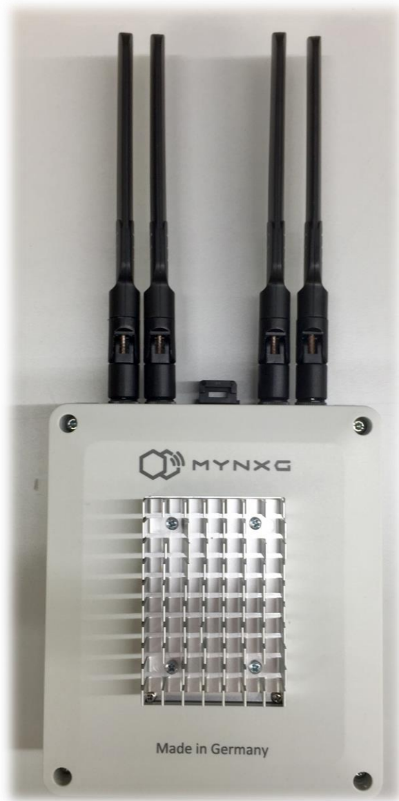
Figure 4: MYNXG EDGE FCR 3 with antennas
