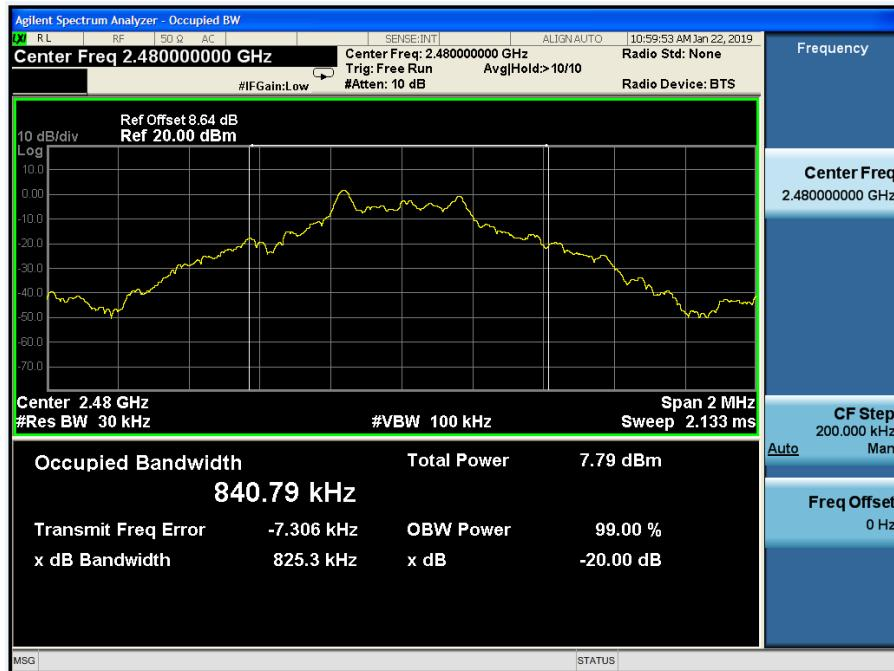
Test Mode:  $\pi/4$ DQPSK
