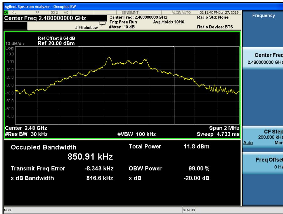
Test Mode:  $\pi/4$ DQPSK
