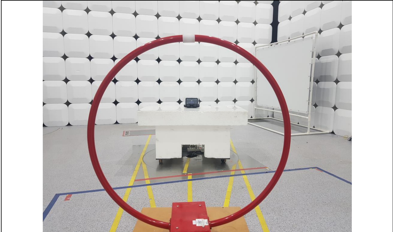
Test distance : 3 m, height of table : 0.8 m
