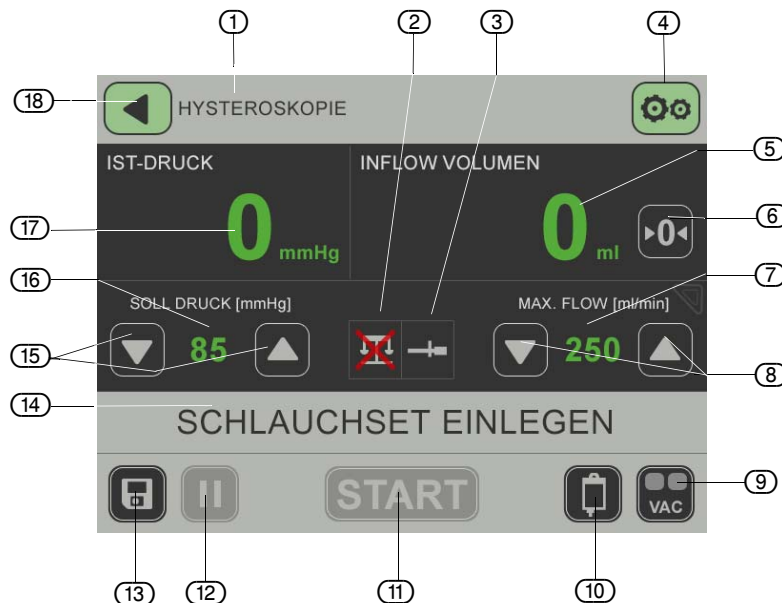
Abb. 9-2 Bildschirmanzeigen Hysteroskopie bei nicht angeschlossener Bilanzierungseinheit
