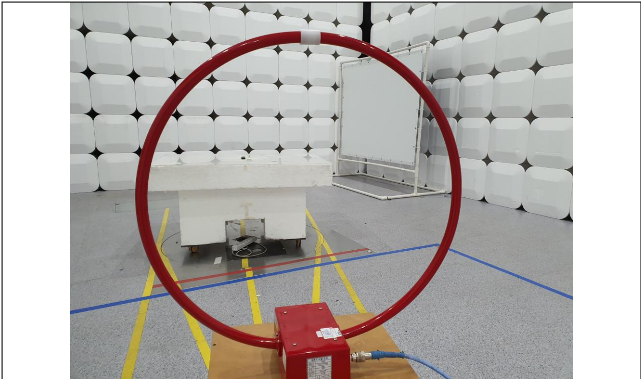
Test distance : 3 m, height of table : 0.8 m
