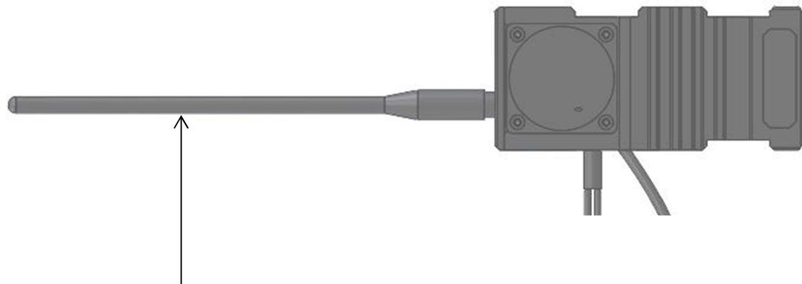
TIGHTEN THE ANTENNA TO THE ANTENNA PORT.
