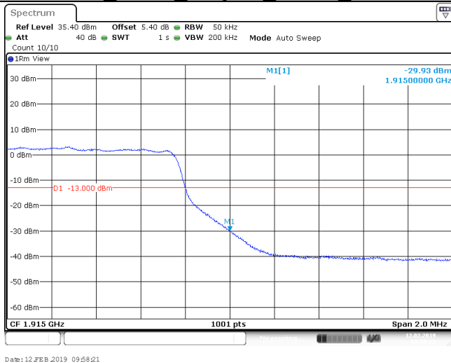
Band25 10MHz QPSK 26090 1RB#0
