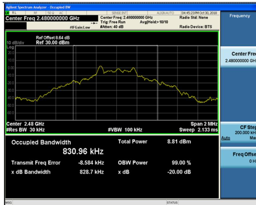
Test Mode:  $\pi/4$ DQPSK
