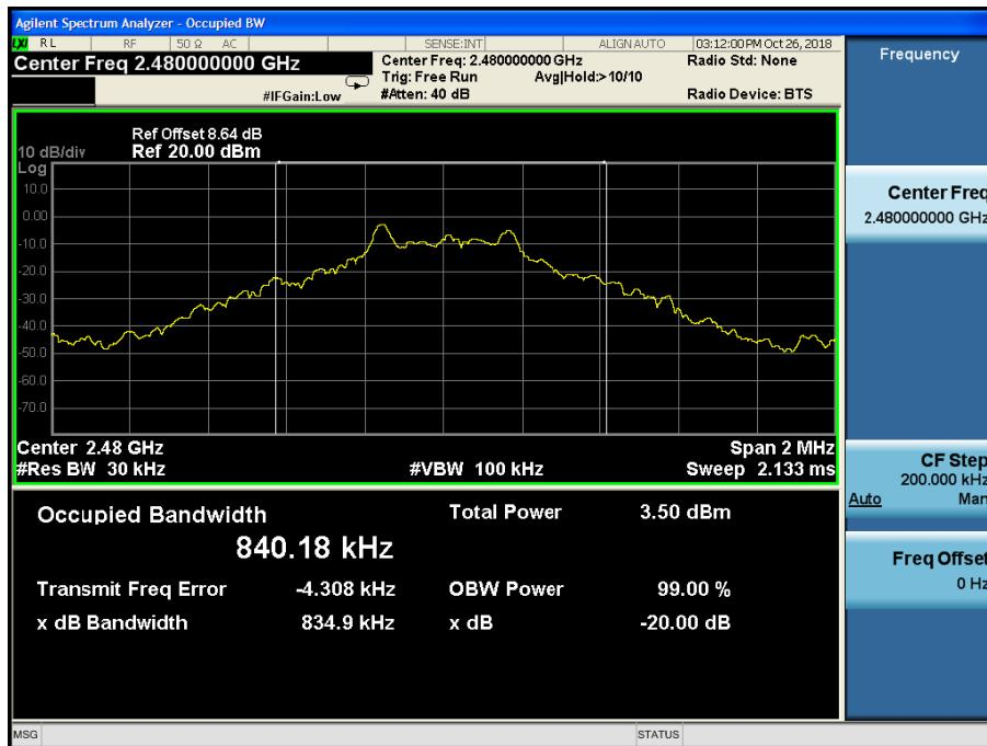
Test Mode:  $\pi/4$ DQPSK
