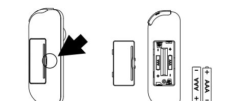
Öffnen Sie wie abgebildet die hintere abdeckung der fernbedienung und legen Sie zwei AAA-batterien (nicht im lieferumfang enthalten) ein.
