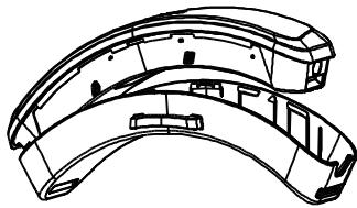
1. 先将电池充电口端下方的空穴插入电池仓套接处。
