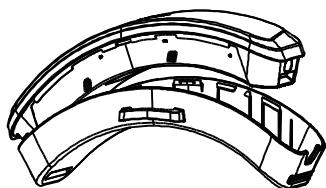
一只手的手指拨住卡扣处的拨动开关,同时另一手的手指从卡扣上方的凹槽处向上扣动电池,直到电池和电池仓完全分离。
