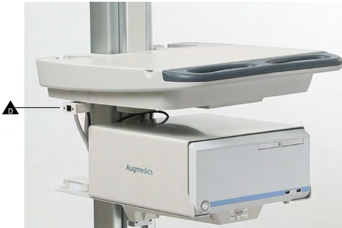
Figure: Plugging Ethernet (D) - WS-Cart configuration
