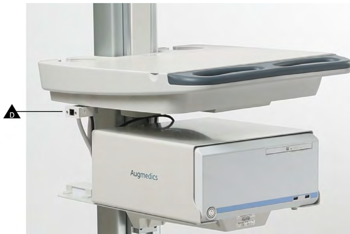
Figure: Plugging Ethernet (D) - WS-Cart configuration
