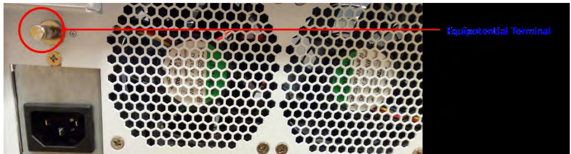
Figure 5-1: USM-500 Equipotential Terminal Pin
