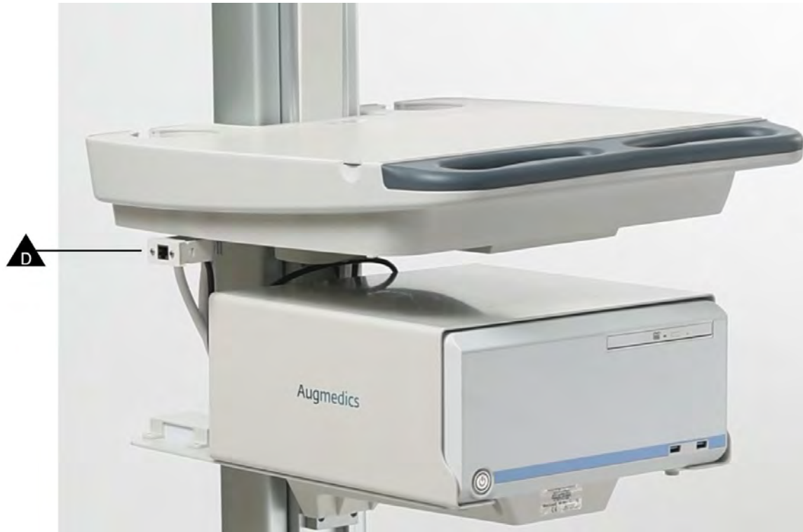
Figure: Plugging Ethernet (D) - WS-Cart configuration
