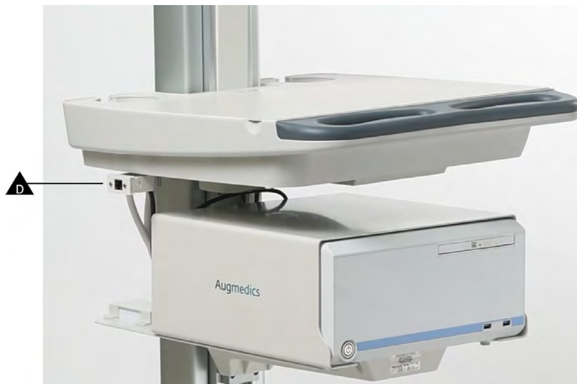
Figure: Plugging Ethernet (D) - WS-Cart configuration
