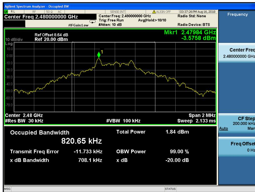
Test Mode:  $\pi/4$ DQPSK
