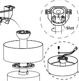
**ENSURE TAB IS SEATED IN A SLOT IN THE HANGER BALL.**
