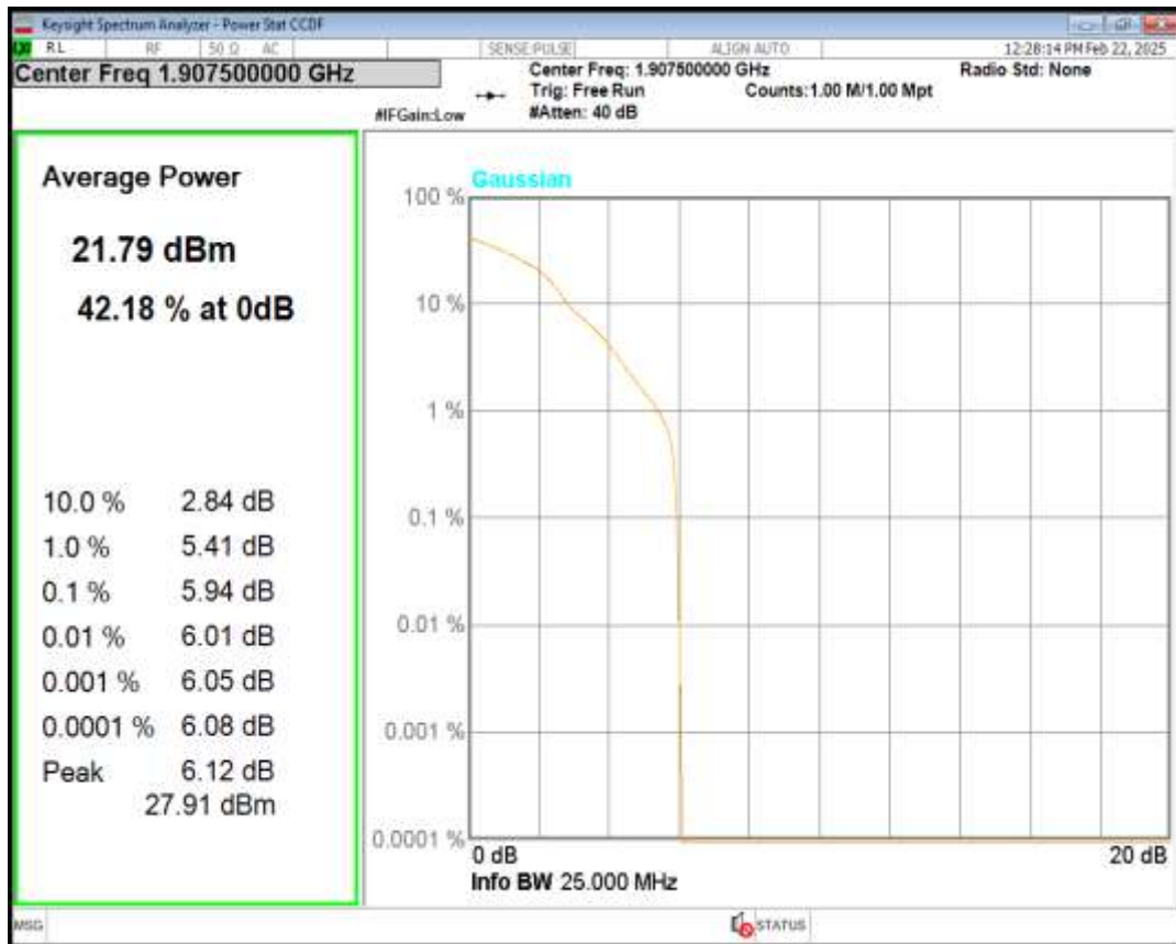
Band2 QPSK BW=10MHz Channel=18650 RB Size=1 Position=#0
