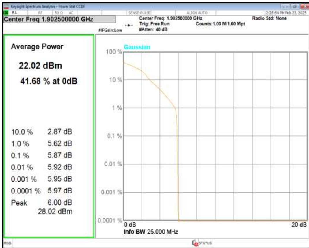
Band2 QPSK BW=20MHz Channel=18700 RB Size=1 Position=#0
