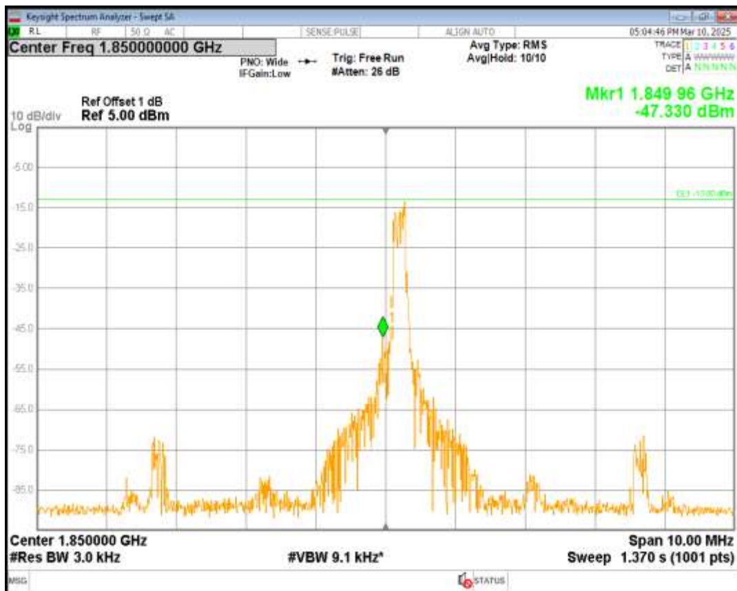
Band2 QPSK Channel=18602 nTones=1@0 Spacing=15kHz
