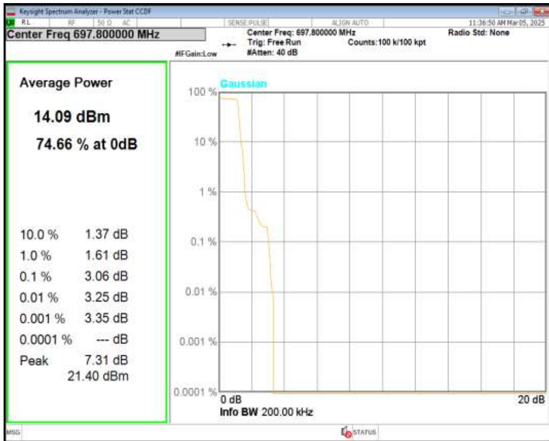
Band71 QPSK Channel=133124 nTones=1@0 Spacing=3.75kHz
