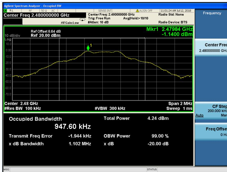
Test Mode:  $\pi/4$ DQPSK
