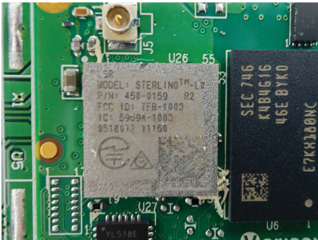
BT/Wi-Fi Module FCC ID: TFB-1003
