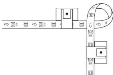
④ Ziehen Sie die Schutzfolie von der Steuerbox ab und kleben Sie sie auf.
