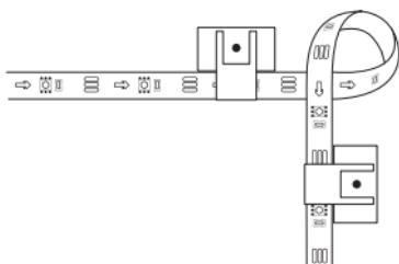
④ コントローラにある3m 両面テープを剥がして、取り付けた表面に粘着してください。
