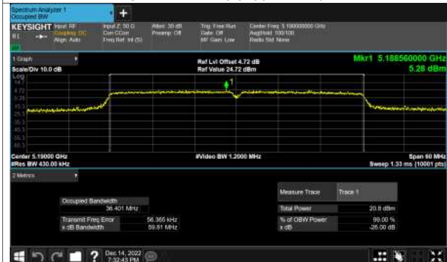
OBW NVNT n40 5230MHz Ant1
