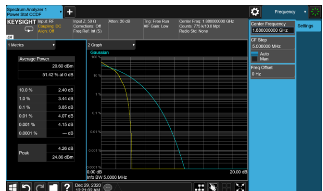
LTE Band 2 QPSK 20MHz CH18900 1RB#49
