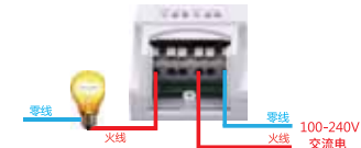
4.2 控制单火线开关正确接线方法 (比如灯具开关)。
