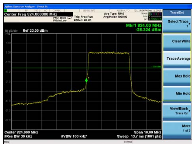
LTE Band 26 QPSK 5MHz CH-Low 1RB
