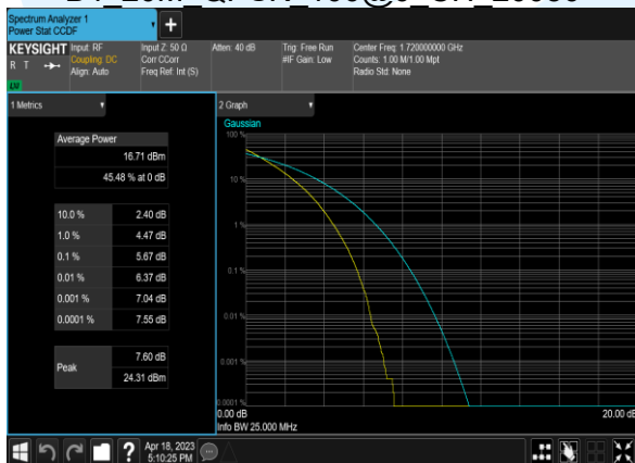
B4 20M QPSK 100@0 CH 20050
