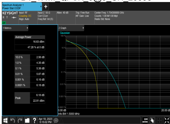
B4 1.4M QPSK 6@0 CH 20393
