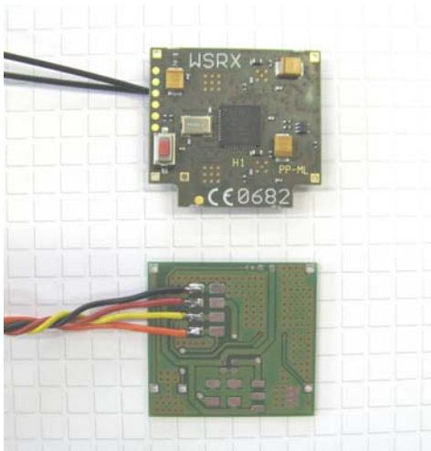
Empfängermodul WSRX und die Basisplatine mit fünf Lötpins verlöten. Der lichte Abstand der Platinen soll  $\geq 3\text{mm}$  sein, damit die Antennenstecker nicht die Basisplatine berühren.
