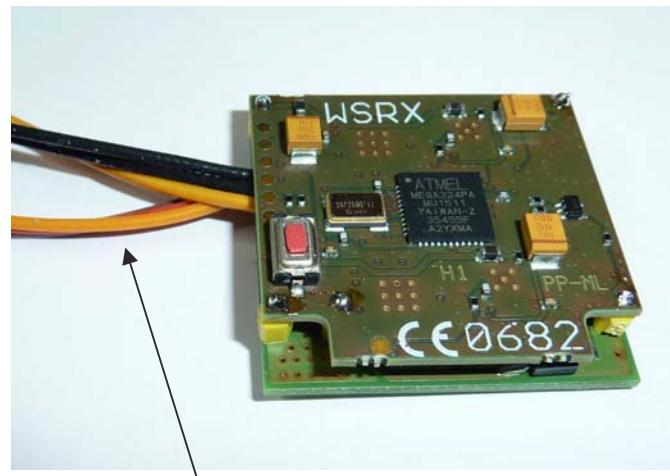
An das 3- bzw. 4-adrige Kabel werden die Crimpkontakte angecrimpt
