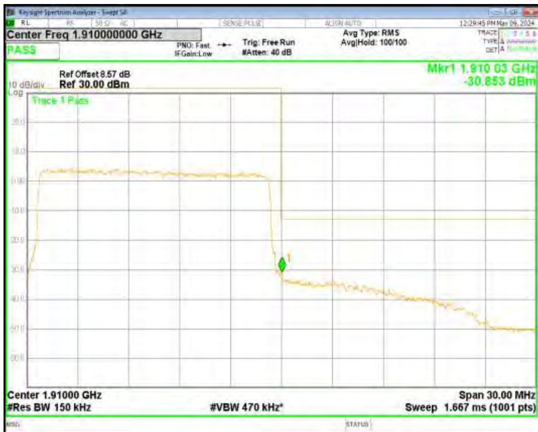
Band2 16QAM BW=20MHz Channel=18700 RB Size=100 Position=#0
