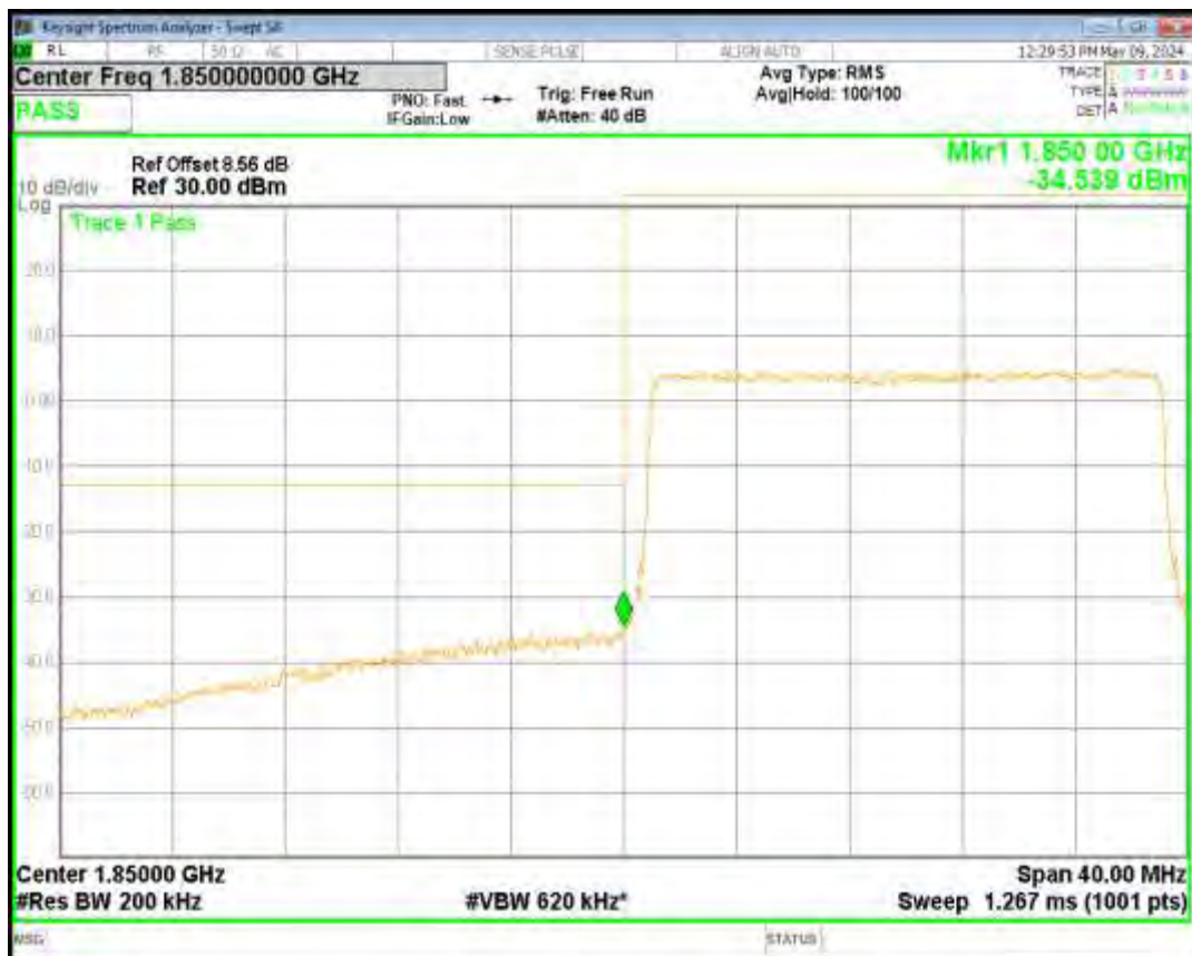
Band2 QPSK BW=20MHz Channel=19100 RB Size=100 Position=#0
