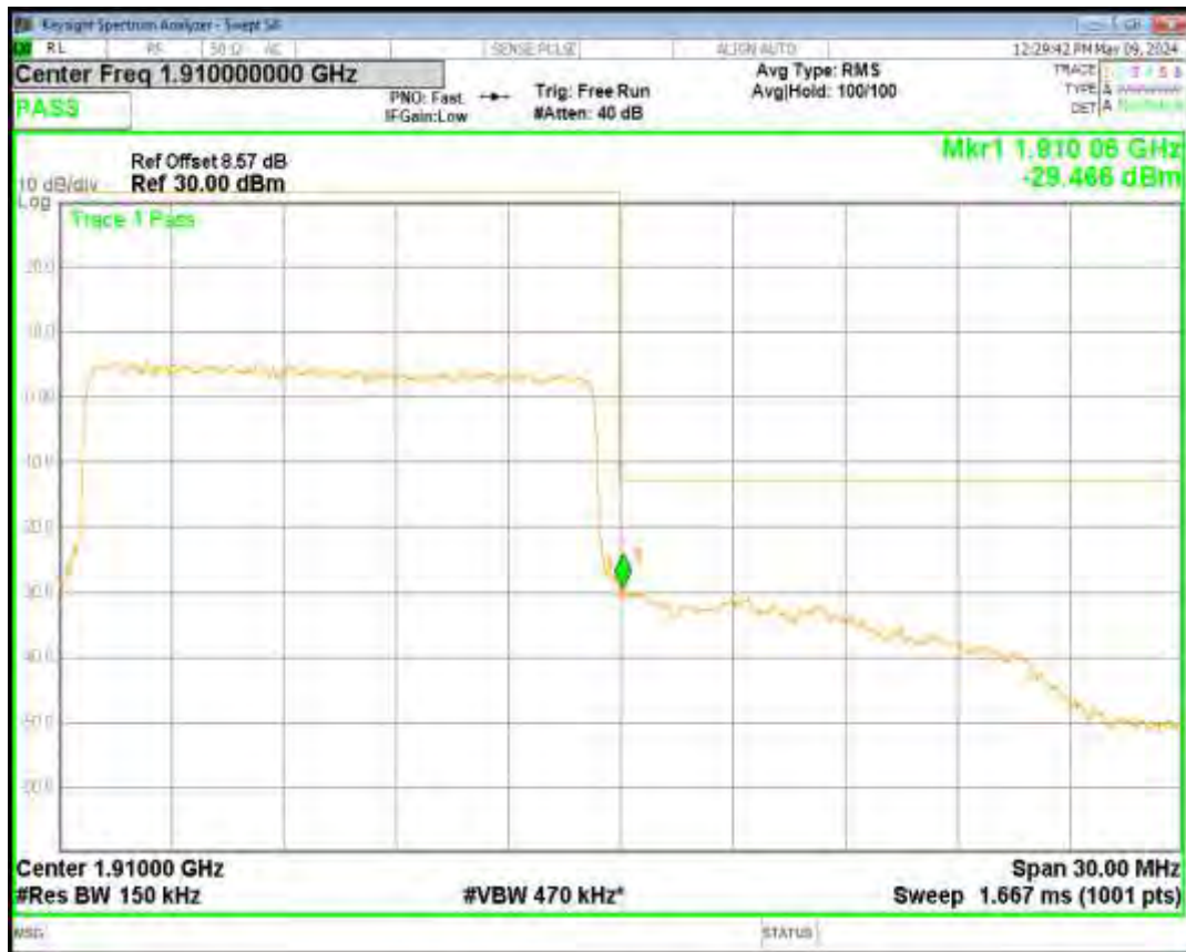
Band2 QPSK BW=20MHz Channel=18700 RB Size=100 Position=#0
