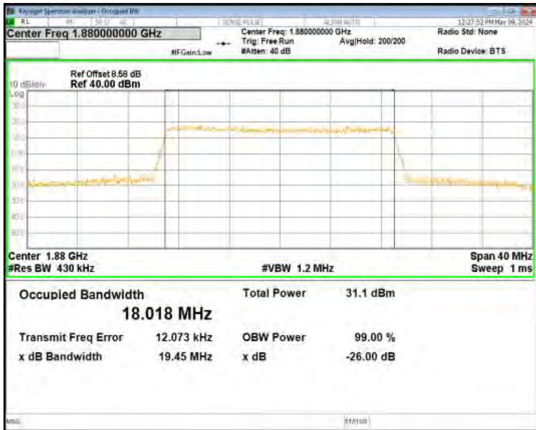
Band2 QPSK BW=20MHz Channel=19100 RB Size=100 Position=#0
