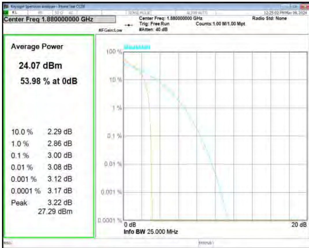
Band2 QPSK BW=10MHz Channel=18650 RB Size=1 Position=#0
