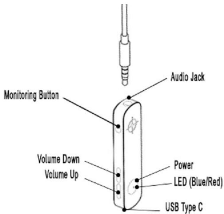
스마트 블루투스 리시버는 무선기능을 지원하지 않는 일반 이어폰이나 GPCI를 지원하는 스마트 이어폰을 무선으로 스마트 기기(휴대폰, 테블릿, 노트북등)와 연결하여 음악청취나 통화를 할 수 있는 기기입니다.
