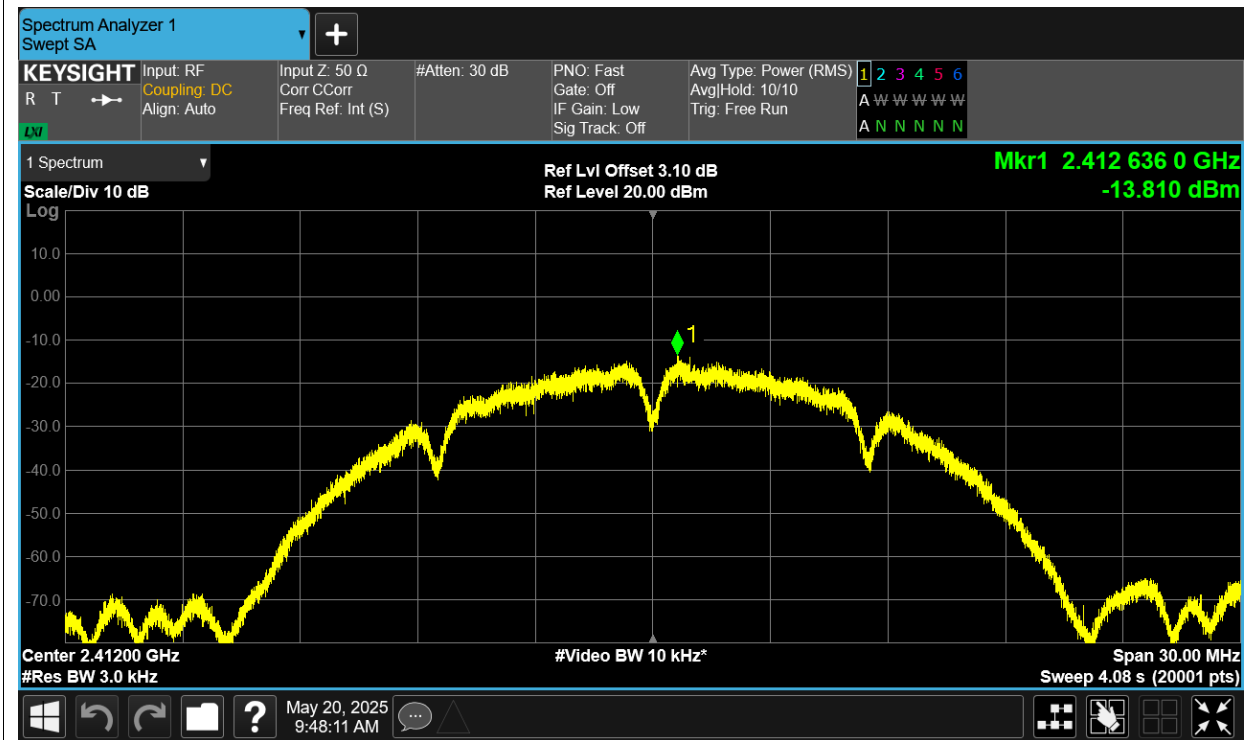
PSD NVNT b 2437MHz Ant1
