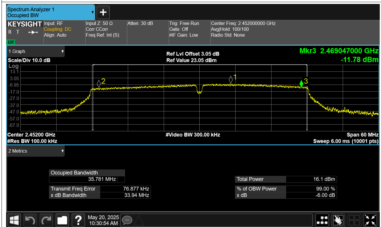
-6dB Bandwidth NVNT n40 2452MHz Ant1
