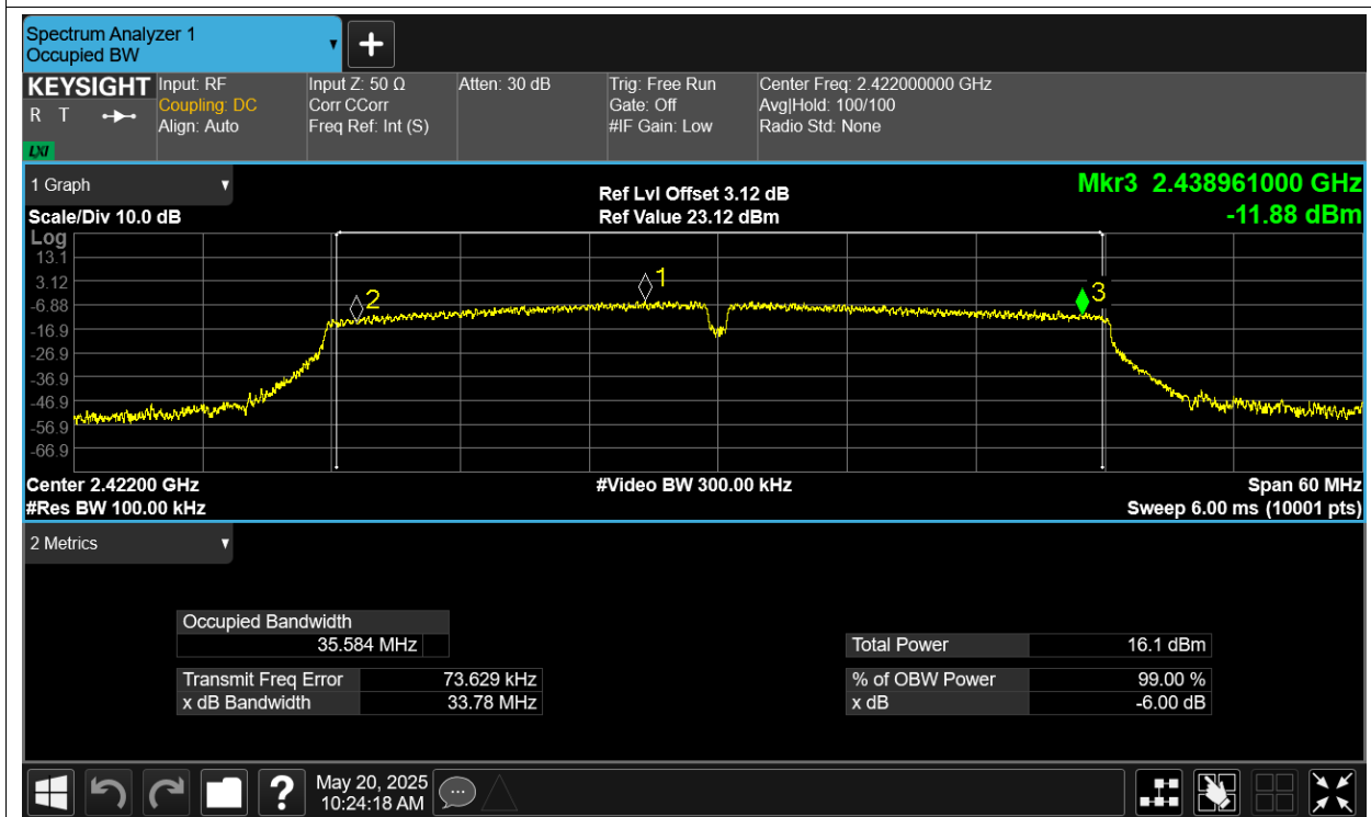
-6dB Bandwidth NVNT n40 2437MHz Ant1
