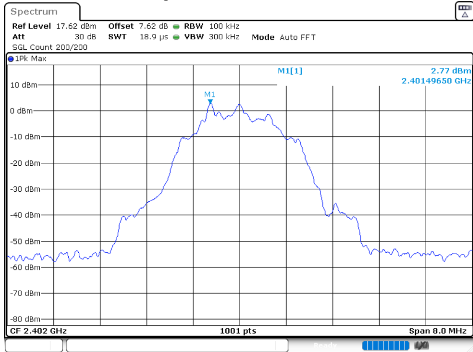
Band Edge NVNT BLE 2402MHz Ant1 Ref
