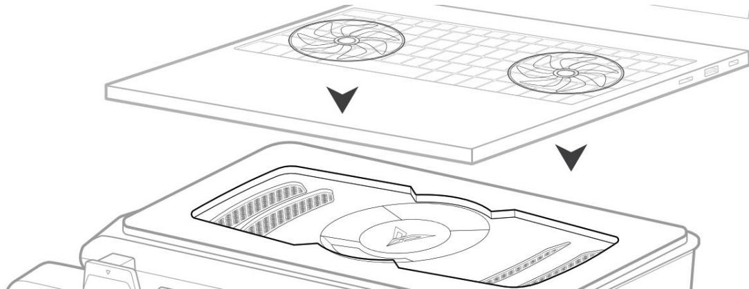
6. 可拆清灰 取出外置防尘网架,支持水洗、刷等操作清灰
