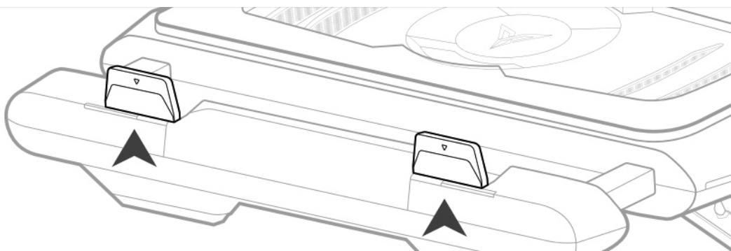
3. 确定高度 抠出脚架,调整到合适的高度
