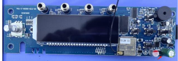
Adds capacitance C5
