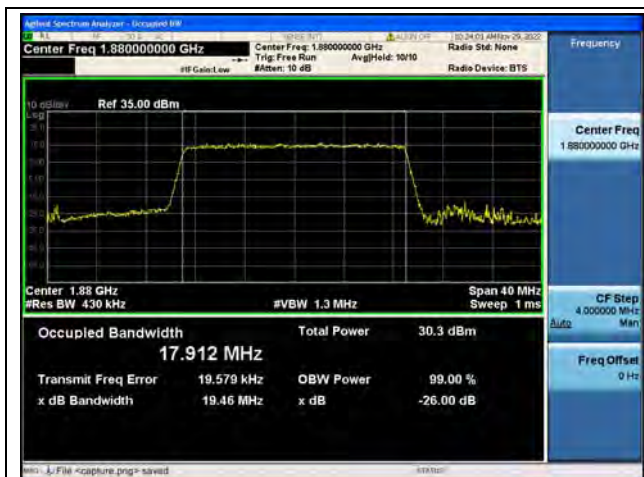
Band2 / 20MHz / QPSK/ Mid CH
