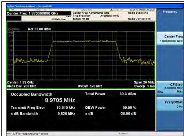
Band2 / 10MHz / QPSK/ Mid CH
