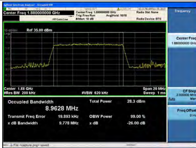
Band2 / 10MHz / 64QAM/ Mid CH
