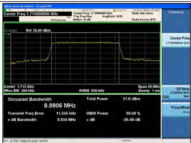
Band4 / 10MHz / QPSK/ Low CH
