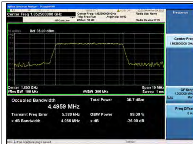
Band2 / 5MHz / QPSK/ Low CH
