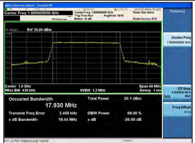
Band2 / 20MHz / QPSK/ High CH
