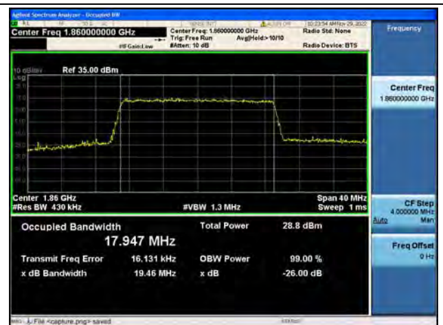
Band2 / 20MHz / 64QAM/ Low CH
