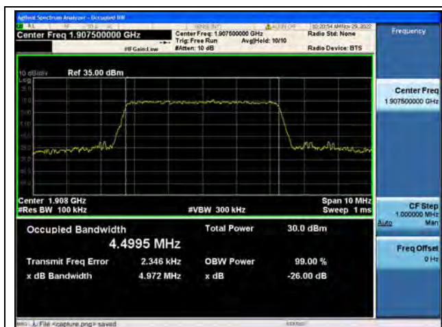
Band2 / 5MHz / QPSK/ High CH
