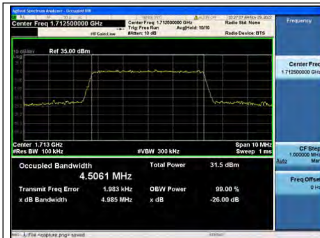
Band4 / 5MHz / QPSK/ Low CH
