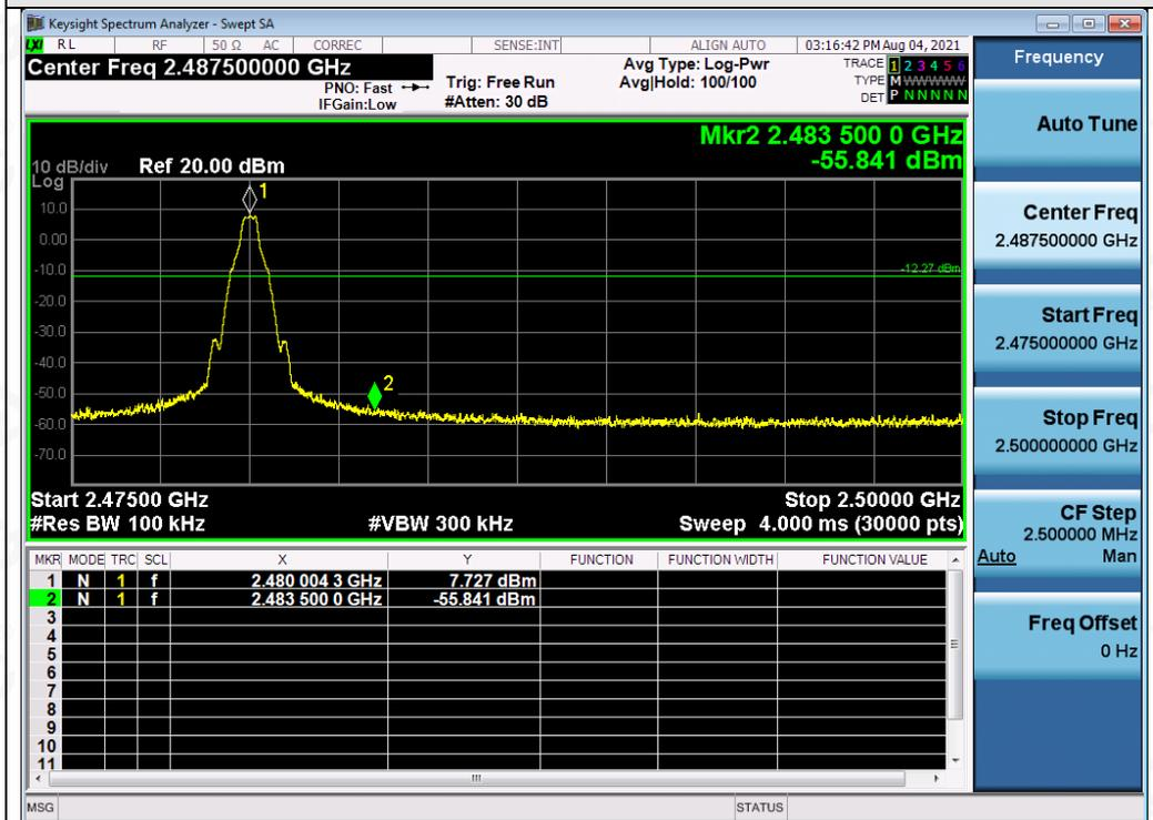
Test\_Graph\_BR\_ANT1\_2480\_1Mbps\_Higher Band Edge Emissions
