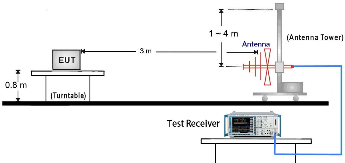
1GHz ~ 25GHz Test Setup:
