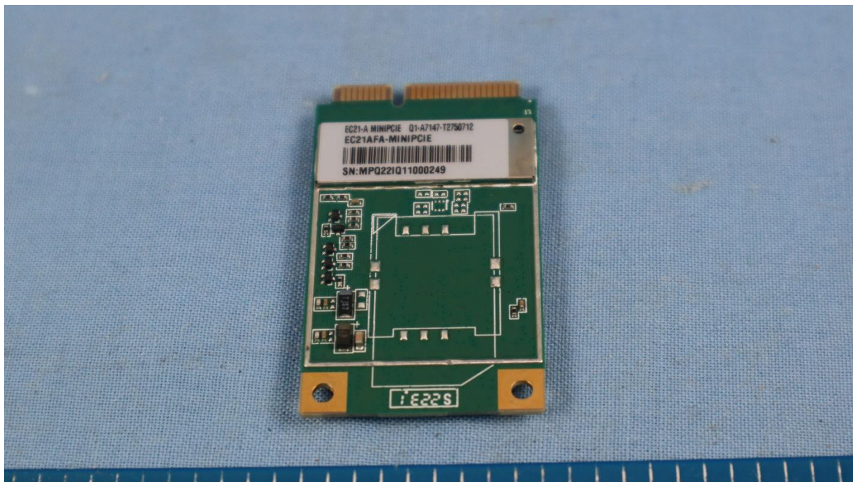
Internal LTE Module Bottom
