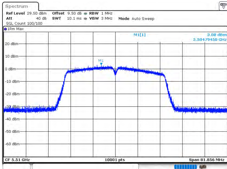
PSD NVNT 802.11n(HT40) 5510MHz Ant1
