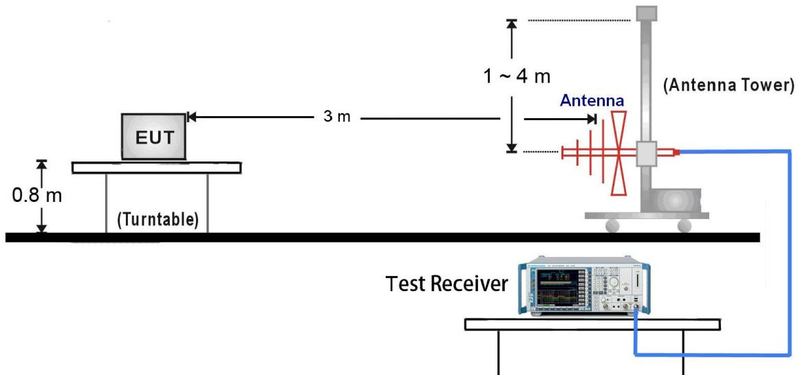
1GHz ~ 25GHz Test Setup:
