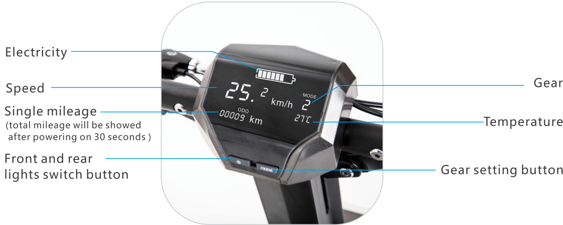
1)Diagram & usage of VA meter display screen
