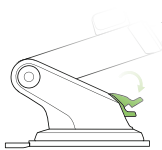
3. Enclenchez le levier de verrouillage vers le bas pour mettre en œuvre la succion.
