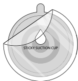
2. Retirez le film protecteur de la ventouse puis appuyez-la fermement sur la surface plane du tableau de bord.
