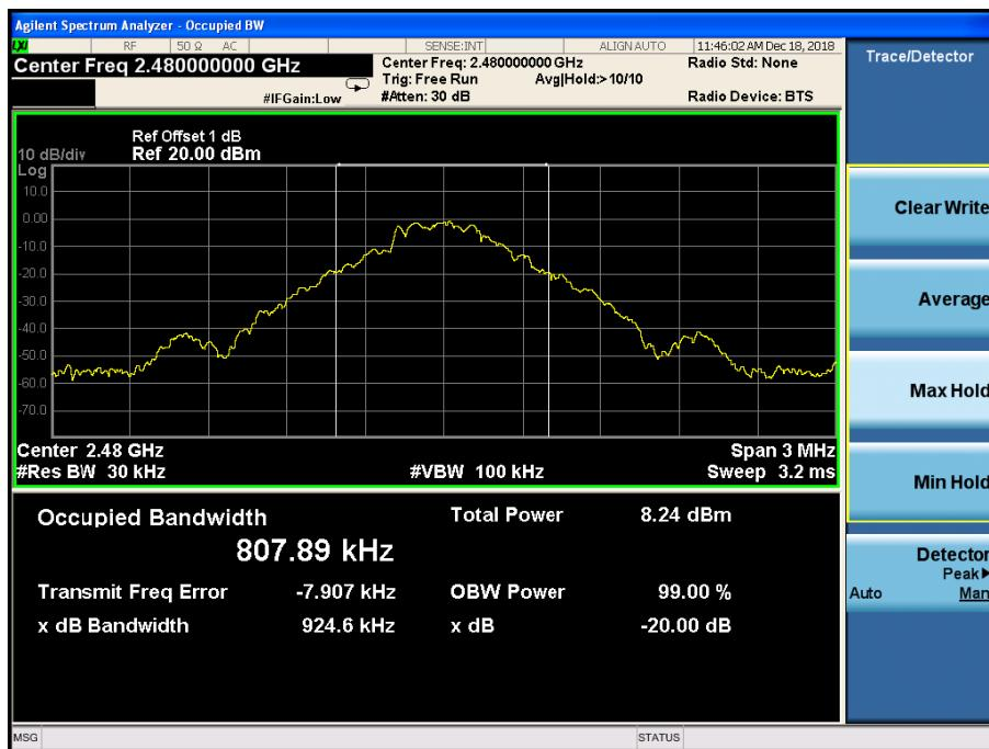
Test Mode:  $\pi/4$ DQPSK
