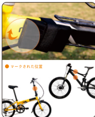
2. 位置を固定し、マジックベルトによってモバイルバッテリーを自転車のブラケットに取り付ける。
