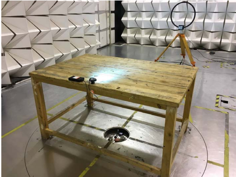
For 30MHz-1000MHz Test Site 2#
