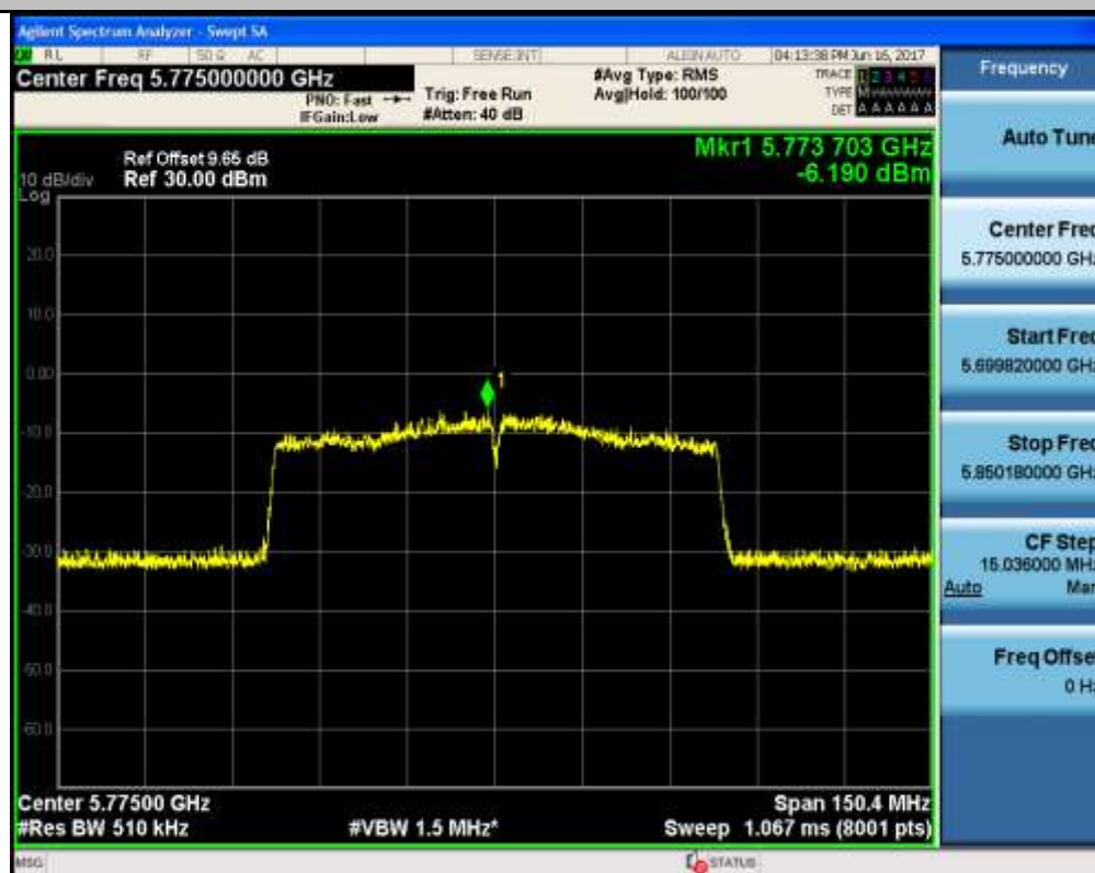
Maximum Conduct Output Power_TNVN_11AC80_5775_Ant1
